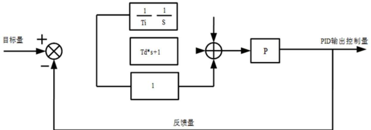
图 6-28 过程 PID 原理框图
