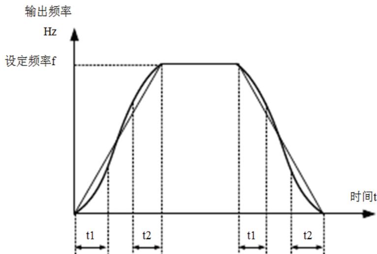
图 6-15 S 曲线加减速 A 示意图
