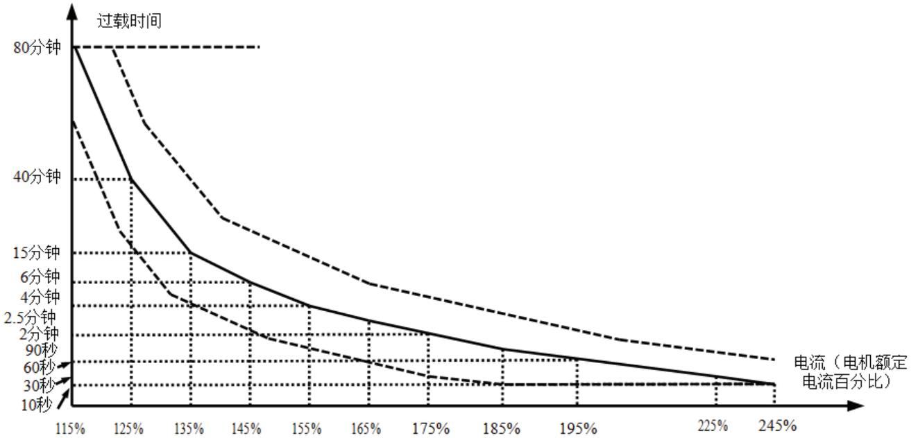
图 6-26 电机过载保护反时限曲线示意图
