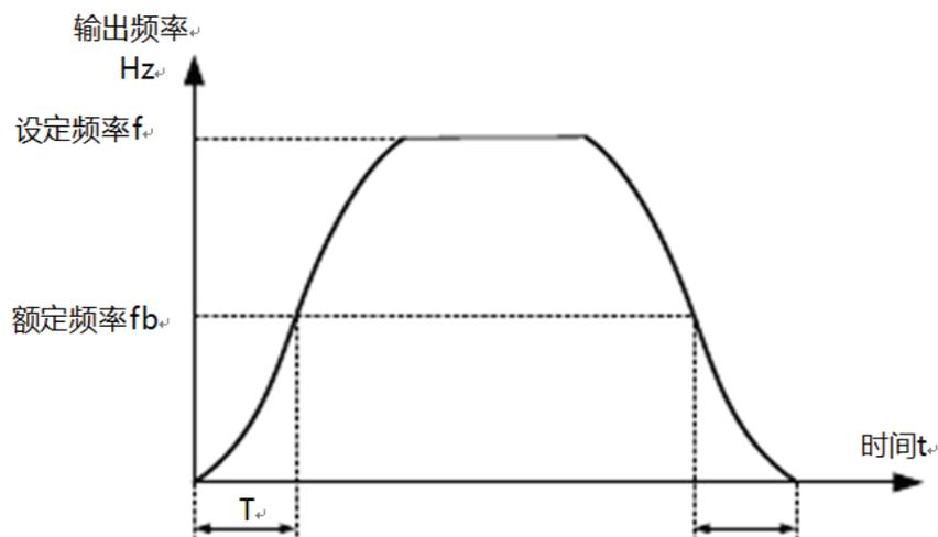
图 6-15 S 曲线加减速 B 示意图
